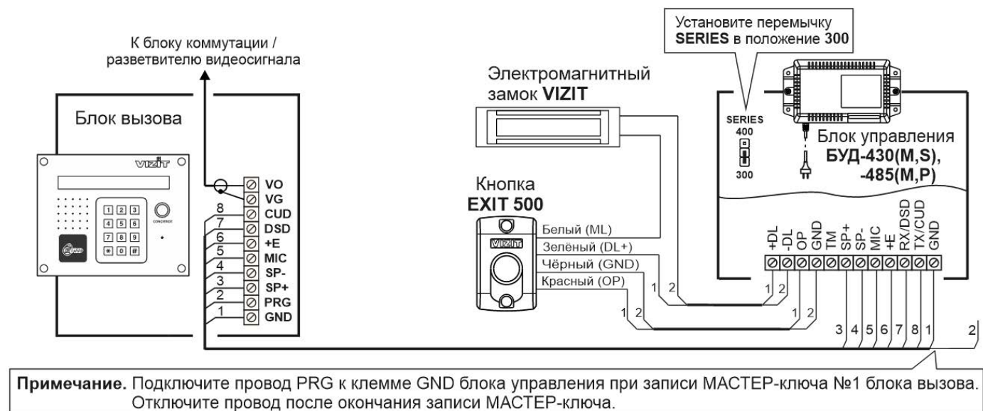
Рисунок 8.2 – Схема соединений блока вызова с блоком управления БУД-430(М,С), -485(М,Р), электромагнитным замком VIZIT-ML400 и кнопкой EXIT 500
