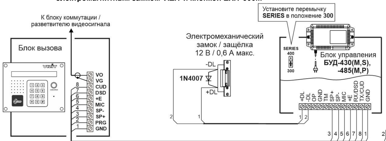
Рисунок 8.3 – Схема соединений блока вызова с блоком управления БУД-430(М,С), -485(М,Р), электромагнитным замком VIZIT и кнопкой EXIT 300М
