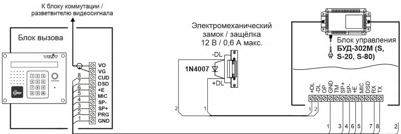
Рисунок 8.7 – Схема соединений блока вызова с блоком управления БУД-302М (S, S-20, S-80), электромагнитным замком VIZIT-ML400 и кнопкой EXIT 300M
