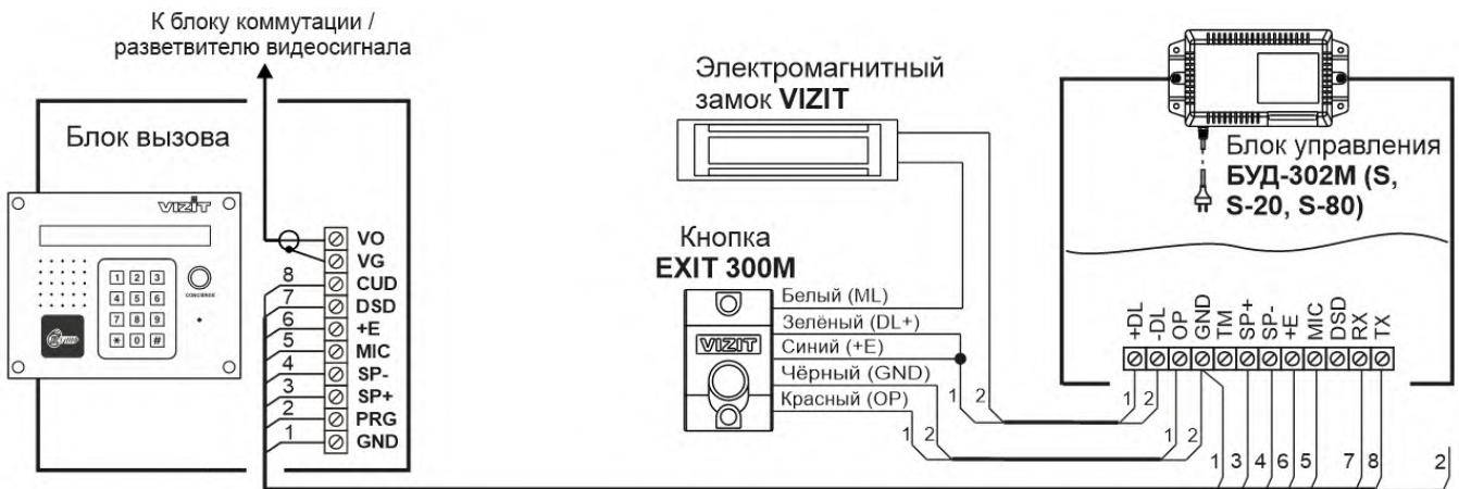
Рисунок 8.6 – Схема соединений блока вызова с блоком управления БУД-302М (S, S-20, S-80), электромагнитным замком VIZIT-ML400 и кнопкой EXIT 500
