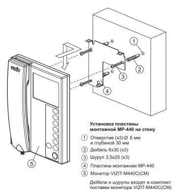
Пластина монтажная **MP-440** предназначена для установки на стену монитора VIZIT-M440C или VIZIT-M440CM.
