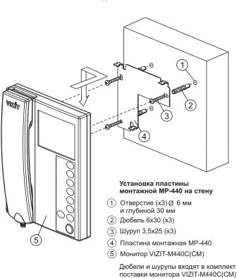
Пластина монтажная **MP-440** предназначена для установки на стену монитора VIZIT-M440C или VIZIT-M440CM.
