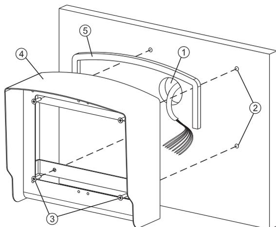
Используйте защитный козырёк как шаблон при разметке отверстий и ниши для блока вызова
