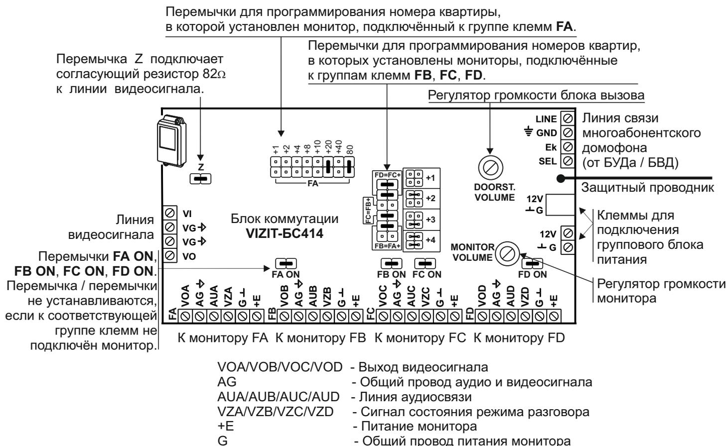
Рисунок 3 - Расположение клемм, назначение цепей и переключек
