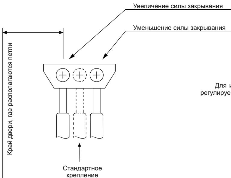
Для изменения силы закрывания двери перемещайте узел крепления регулируемого рычага к башмаку так, как показано на рисунке слева.
