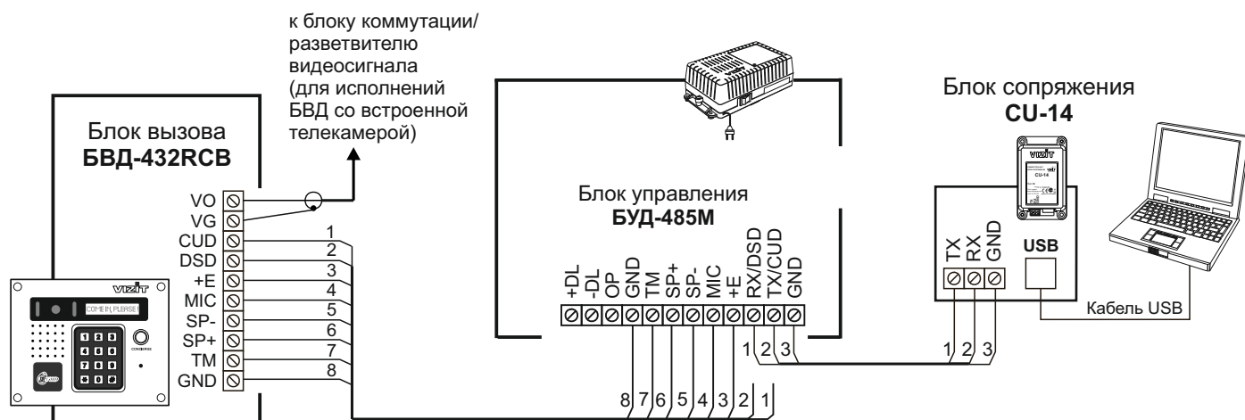
Схема соединений блока управления БУД-485М с блоком сопряжения CU-14 и компьютером
