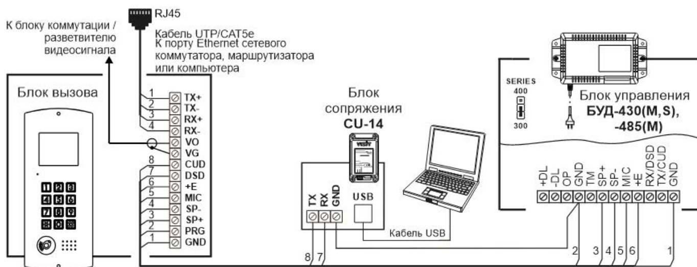
Рисунок 16.1 - Схема соединений блока вызова с блоками управления БУД-430(S, M), -485(M) и блоком сопряжения CU-14
