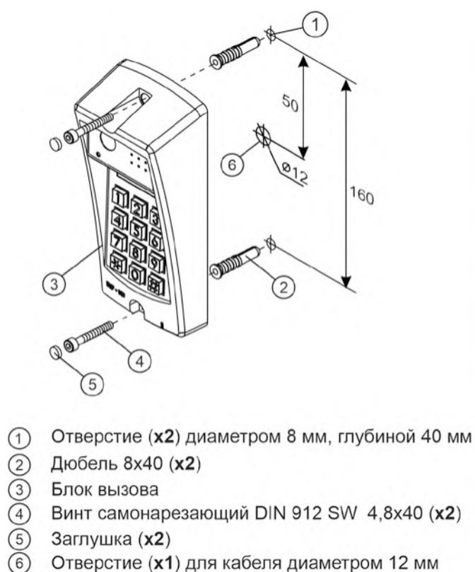
Рисунок 6.2 – Установка блока вызова на стену
