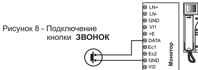
Кнопка **ЗВОНОК** может быть подключена таким же образом ко всем мониторам на вышеприведенных схемах.
